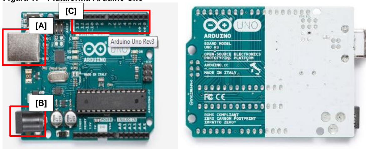
Figura 17 - Plataforma Arduino Uno
