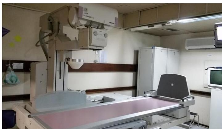
**Figura 3: Equipamento fluoroscópico marca PHILIPS, modelo DIAGNOST 93.**
