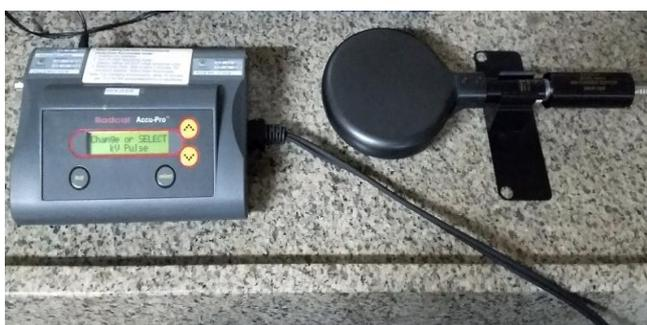
**Figura 4: Eletrômetro e câmara de ionização de placas paralelas.**
