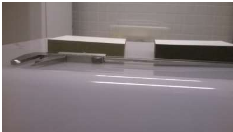
Fotografia 1 – MDF comum não exposto ao teste e MDF Ultra BP exposto. Fonte: Autoria própria.
