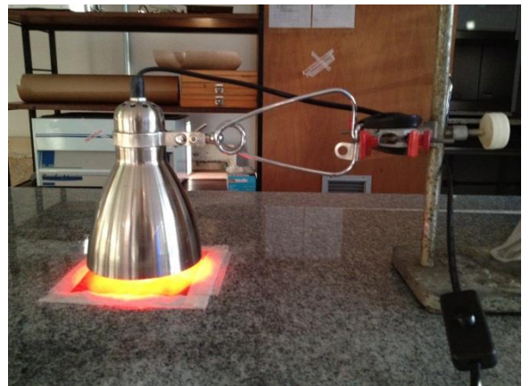
Figura 10 – Foto do bocal E27 fixado no suporte universal – sistema de irradiação (Fonte: o autor)
