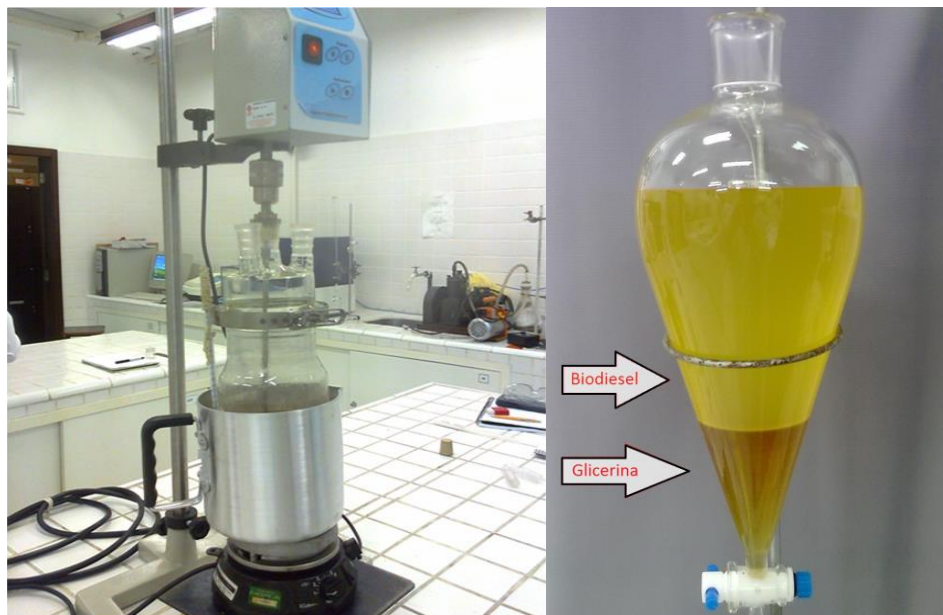
Figura 9. Agitador mecânico de Alto Torque em funcionamento para a produção de biodiesel (esquerda) e funil de separação apresentando biodiesel na fase superior e na fase inferior, a glicerina bruta (direita).
