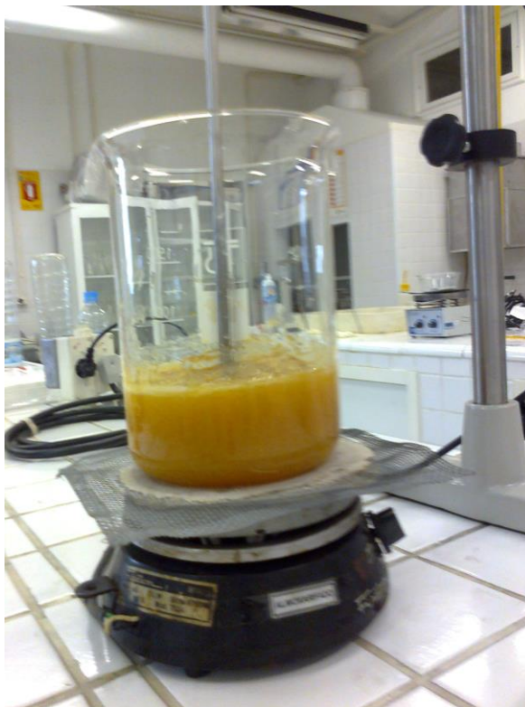
Figura 17. Agitador mecânico de Alto Torque em funcionamento mostrando o sistema utilizado para reação de transesterificação do óleo de soja refinado.
