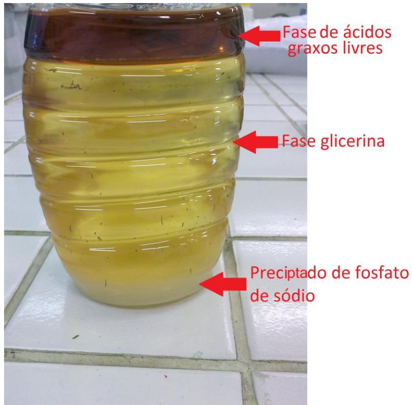
Figura 12. Separação de fases após hidrólise ácida. Ácidos graxos livres na parte superior, glicerina na fase intermediária e o precipitado de fosfato de sódio na fase inferior.
