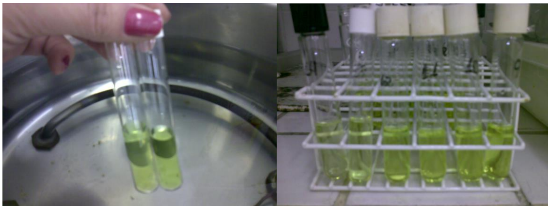
Figura 15. (À esquerda): Tubos colocados em um banho termostático durante 1 minuto a 70°C com agitação manual. (À direita): Tubos de ensaio com os reagentes após o banho termostático apresentando diferença nas cores devido a diferença de concentração de glicerina em cada tubo.
