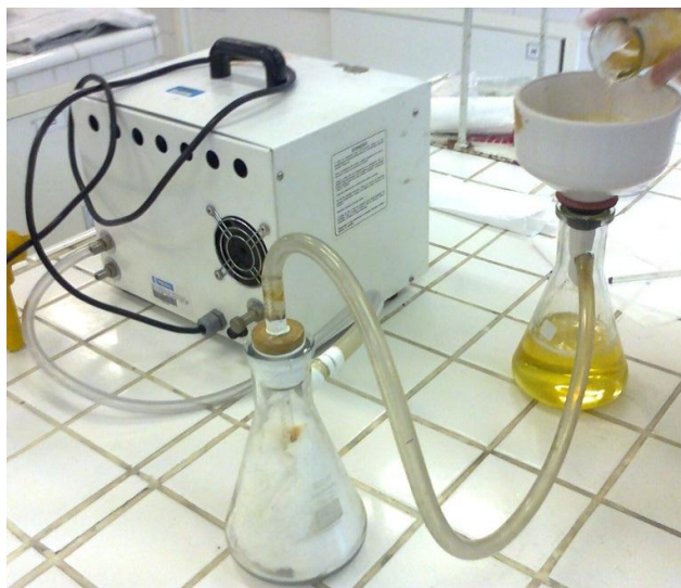
Figura 10 – Sistema de filtração à vácuo do éster metílico de óleo de soja refinado. Fonte: Autoria Própria.
