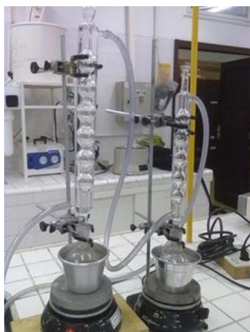
Figura 7 – Sistema utilizado para determinação do índice de saponificação. Fonte: Autoria Própria
