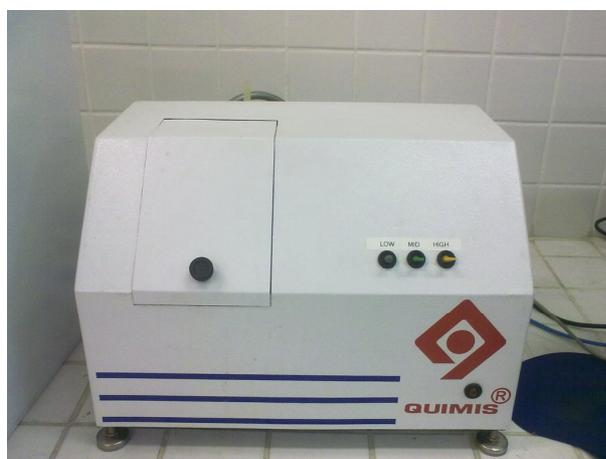
**Figura 12:** Foto do Espectrofluorímetro da *Quimis* - modelo Q-798FIL
