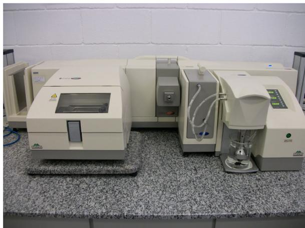
**Figura 9:** Foto do Granulômetro Laser *Mastersizer 2000* da marca *Malvern*
