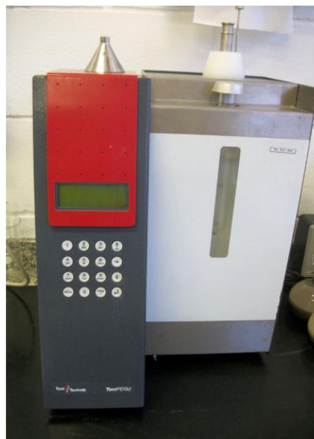
**Figura 16:** Foto do Permeabilímetro de Blaine Semi-automático EN-E196-6 - *Toni Technik*;
