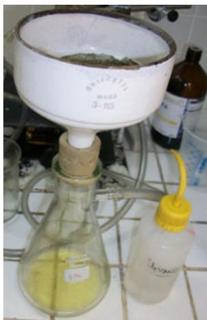
**Figura 3:** Foto do sistema de filtração a vácuo do óleo de soja após purificação com as Argilas
