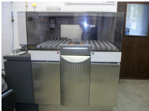
**Figura 6:** Foto do Espectrômetro de Fluorescência de Raios-X, *Magi'X - Pro PW2540 – Phillips*
