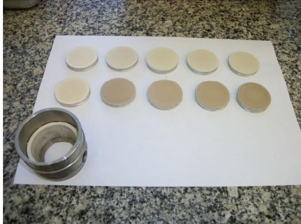
**Figura 7:** Foto das pastilhas das amostras de Atapulgita para análise em FRX
