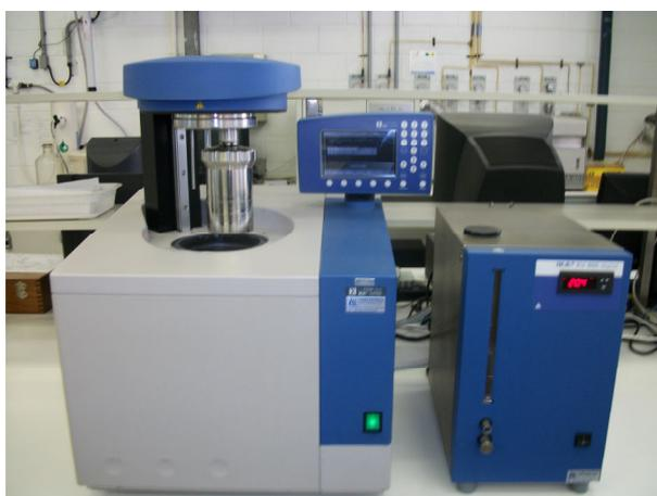
**Figura 10:** Foto do Calorímetro modelo KV 600 digital do fabricante *IKA*;
