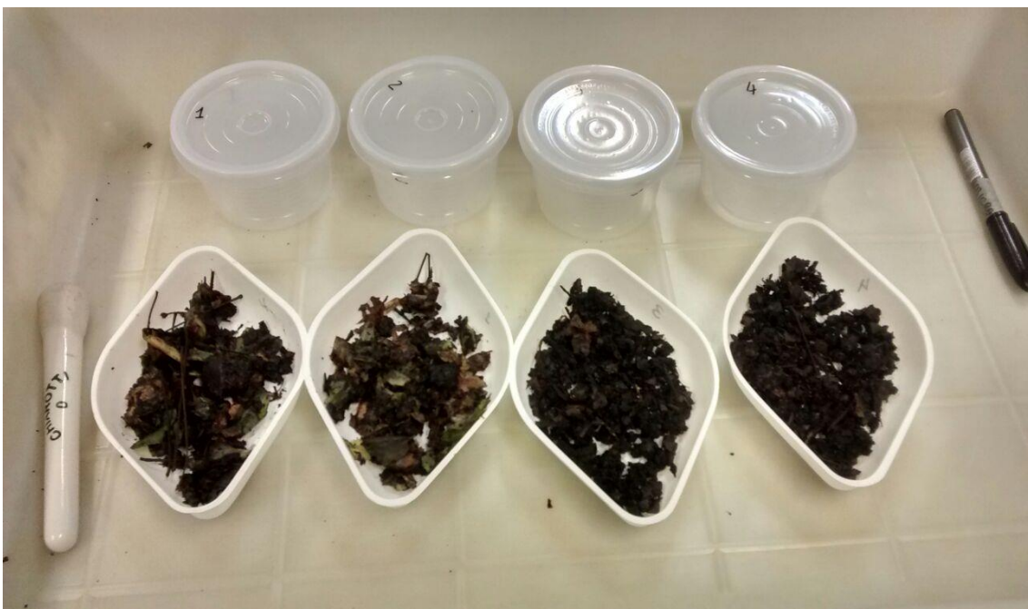
Análise de Peso Seco para determinação do teor de umidade das amostras de inoculante turfoso.
