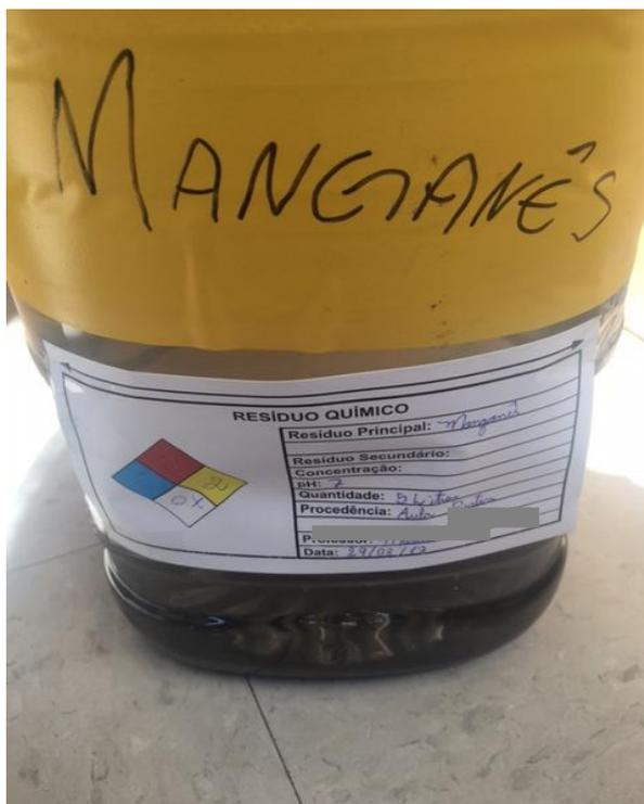
Figura 12 – Exemplo de resíduo com apenas um elemento químico identificado, no caso o íon metálico Manganês.
