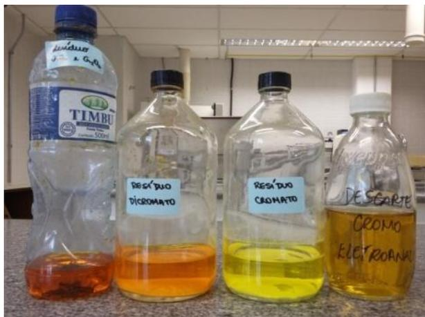
**Figura 4 – Resíduos de cromo provenientes do Laboratório de Química Analítica.**
