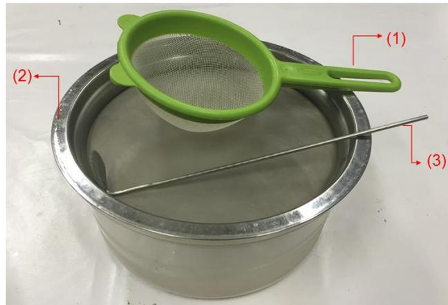
Figura 3: Material para separação de *Daphnia magna*, sendo (1) rede com malha de 1 mm, para retenção das *D. magna* adultas; (2) rede com malha 0,75 mm para retenção dos filhotes e (3) rede com alça metálica, para remoção das carcaças.
