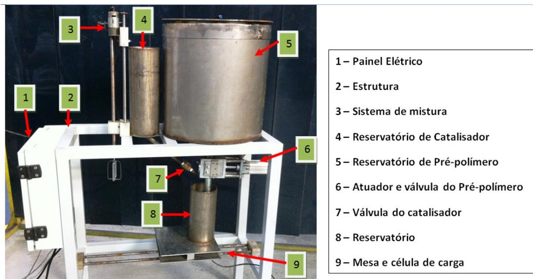
**Figura 7 - Detalhamento do Projeto Mecânico**
