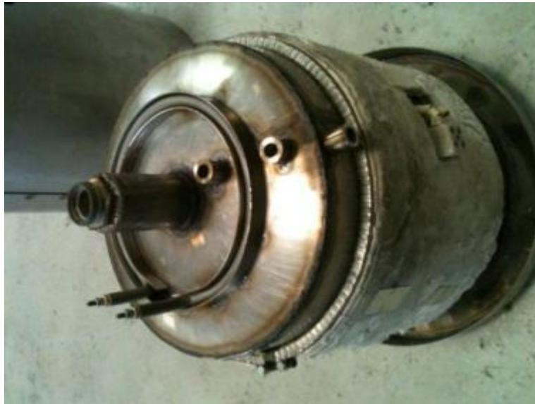
**Figura 31 - Resistência Inferior e a Tipo Coleira Montada na Lateral**
