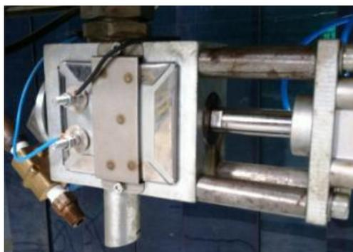
**Figura 24 – Conjunto Montado com a Resistência**
