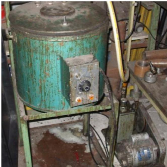
**Figura 1 - Tanque de Pré-Polímero Ligado à Bomba de Vácuo**
