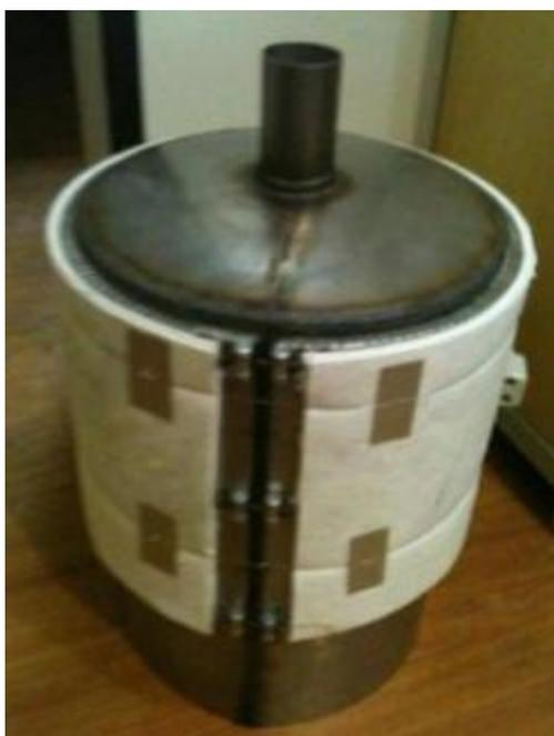
**Figura 18 - Tanque de Pré-Polímero com Resistência Tipo Colar**
