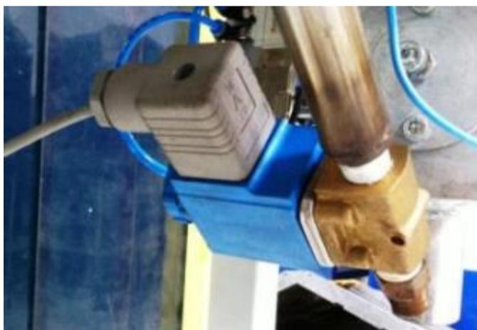
**Figura 28 - Válvula Solenóide com Bobina 24 Vdc**
