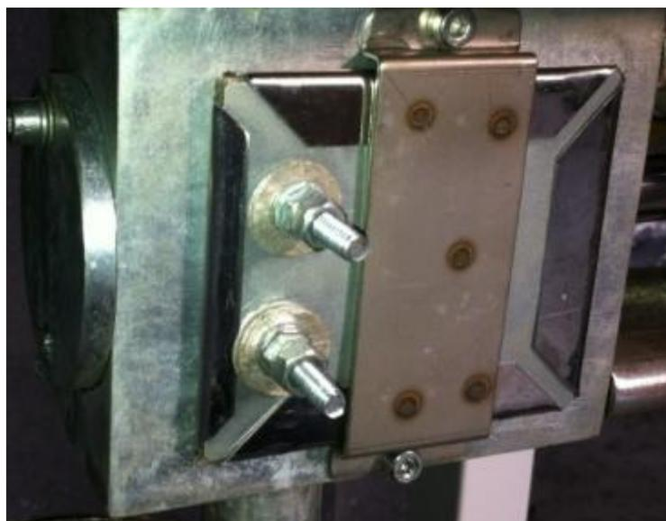
**Figura 33 - Resistência de Placa fixada na Válvula de Bloqueio.**
