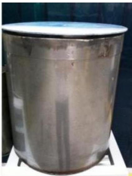
**Figura 20 - Tanque com a proteção externa e tampa**
