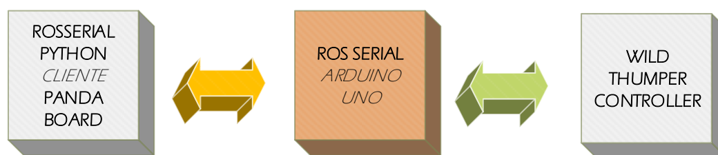
Figura 12 - Arduino Uno em destaque por interface realizada entre ROS e controlador dos motores
