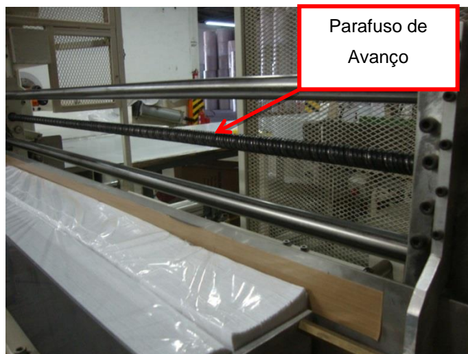
Figura 15- Aplicação do parafuso de avanço na máquina. Fonte: Autoria própria.
