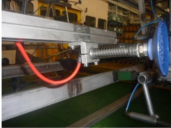
**Fotografia 5 - Disposição da ventosa na garra do Robô 1**
