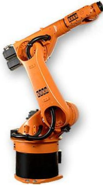
**Figura 12 - Robô industrial com 6 eixos**
