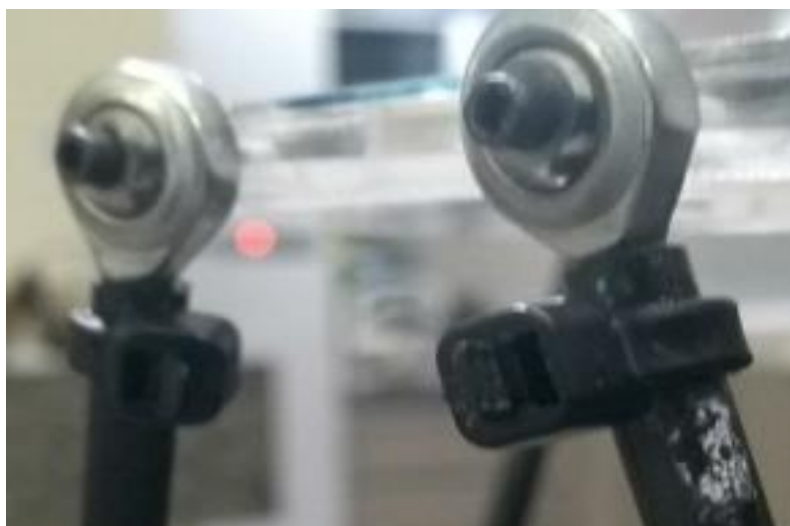
Figura 31 – Reforço alternativo das hastes de fibra de carbono. Fonte: A autoria própria.
