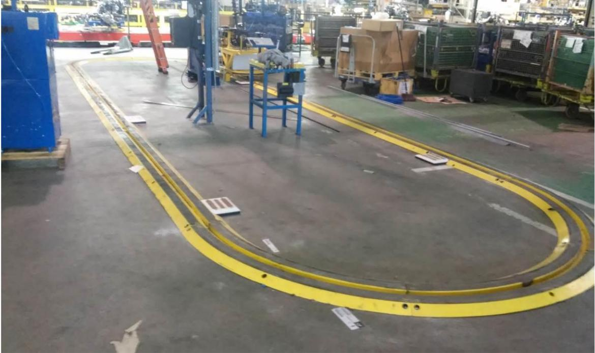
**Figura 33: Trilhos com os pontos fixos de recarga instalados (Fonte: autoria própria).**
