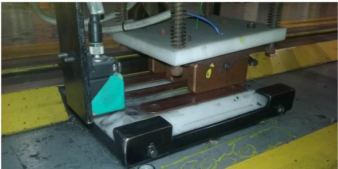
Figura 26: Esquemático e foto do sistema de carga instalado (Fonte: autoria própria).
