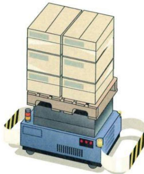
**Figura 3: Ilustração de um exemplo de um AGV (Fonte: IMAM Consultoria, 2016).**
