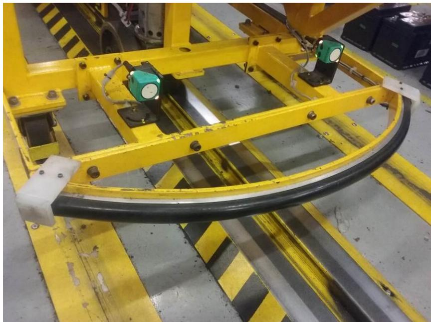
Figura 20: Imagem do *bumper* instalado no dispositivo (Fonte: autoria própria).
