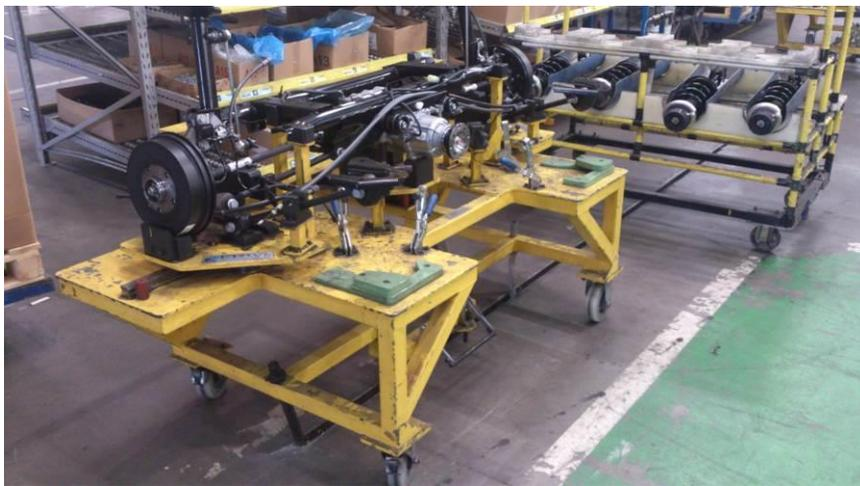
**Figura 1: Dispositivo antigo, com eixo 4x4 montado (autoria própria).**
