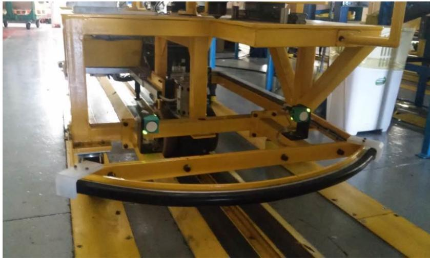
**Figura 30: Foto dos sensores ultrassônicos e o *bumper* de contato (Fonte: autoria própria).**
