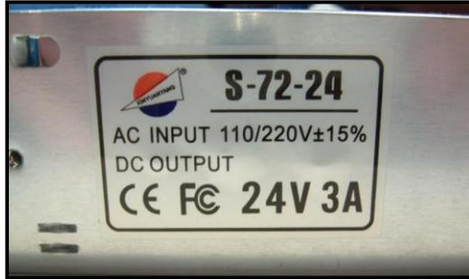
Figura 24 - Especificações técnicas da fonte.
