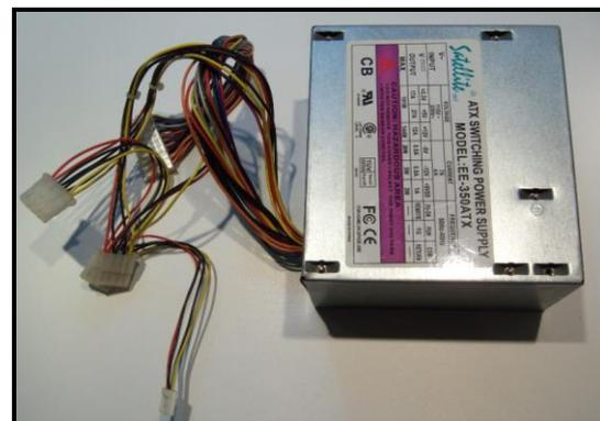
Figura 27 - Conectores de ligação da fonte.
