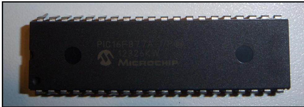
**Figura 18 - Microcontrolador PIC 16F877A.**
