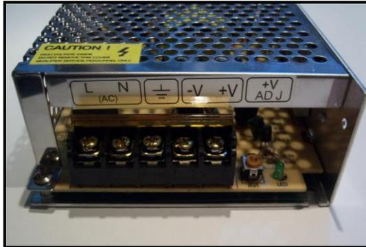
Figura 25 - Bornes de ligação da fonte.
