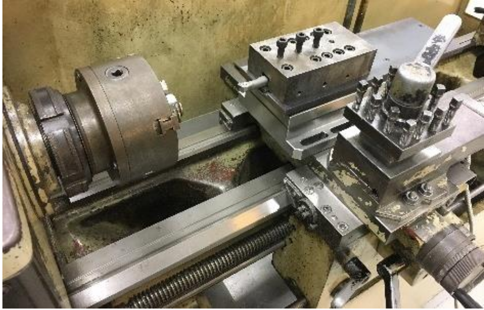
Figura 9 – Torno com placa Kistler, Porta Ferramenta e Ferramenta montado. Fonte: Autoria Própria
