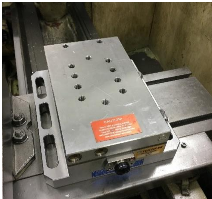
Figura 8 – Torno com placa Kistler em processo de montagem. Fonte: Autoria Própria
