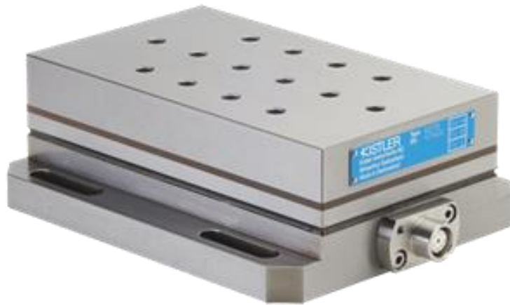
Figura 5 – Plataforma Multicomponente de Medição de Forças KISTLER Type 9257 Fonte: KISTLER INSTRUMENT CORP. [25]
