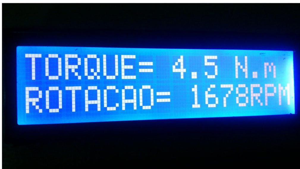
Figura 19 – Tela LCD exibindo Torque e Rotação.
