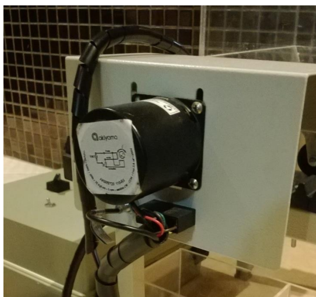
Figura 14 - Motor de acionamento do eixo principal Fonte: Autoria Própria.
