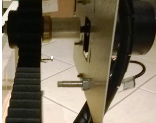
Figura 15 – Detalhe sensor indutivo Fonte: Autoria Própria.
