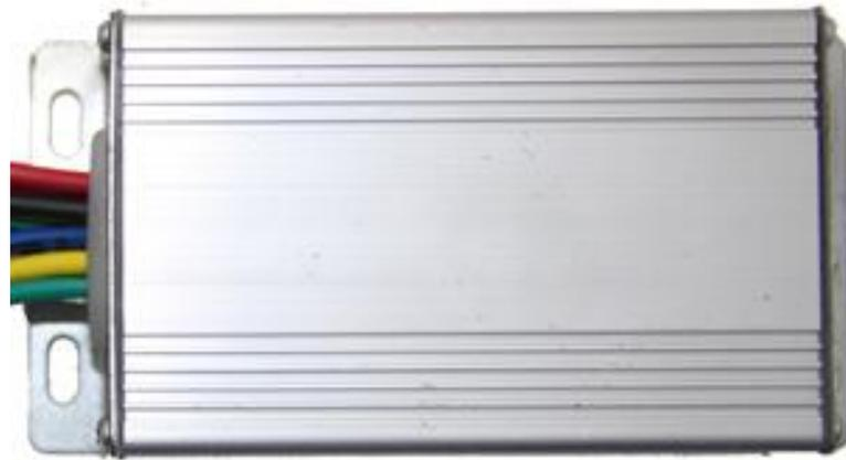
Figura 31 – Controlador do motor BLDC de 36 V.
