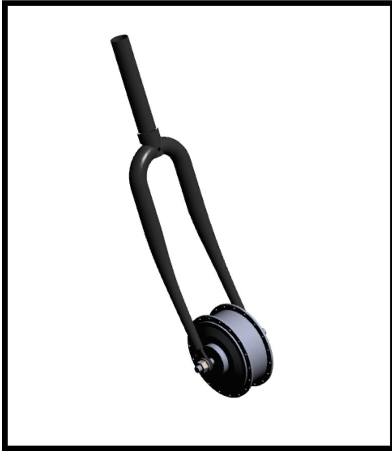
**Figura 39 – Motor fixado no garfo dianteiro.**
