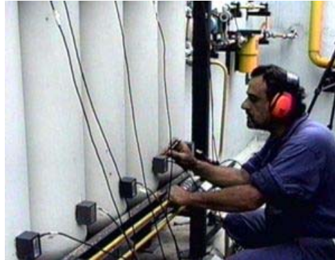
Figura 5 - Sensores para ensaio de emissão acústica em cilindros. Fonte: Eccend (2012).
