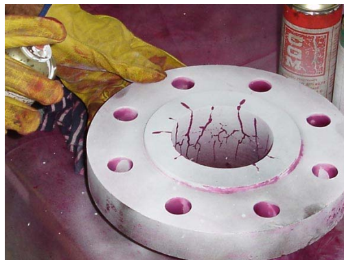
Figura 9 - Ensaio de líquido penetrante em um flange.
