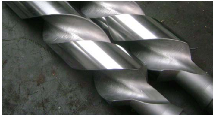
Figura 34 - Fusos movidos após recuperação da superfície do diâmetro externo. Fonte: Relatório de manutenção da bomba.
