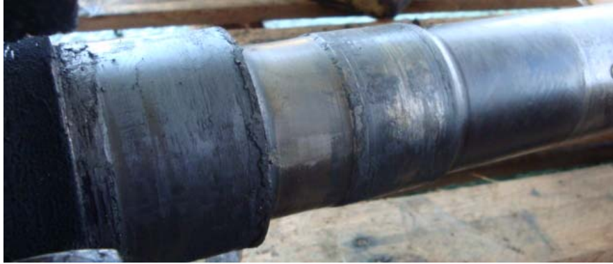
Figura 37 - Assento do rolamento no eixo do motor, mostrando o desgaste excessivo existente.
