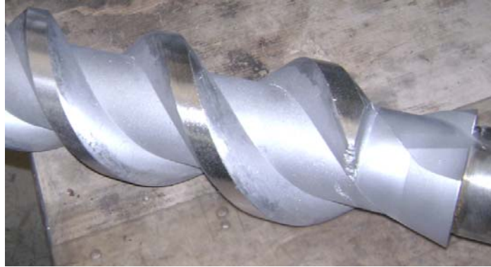
Figura 33 - Fuso principal após recuperação da superfície do diâmetro externo. Fonte: Relatório de manutenção da bomba.
