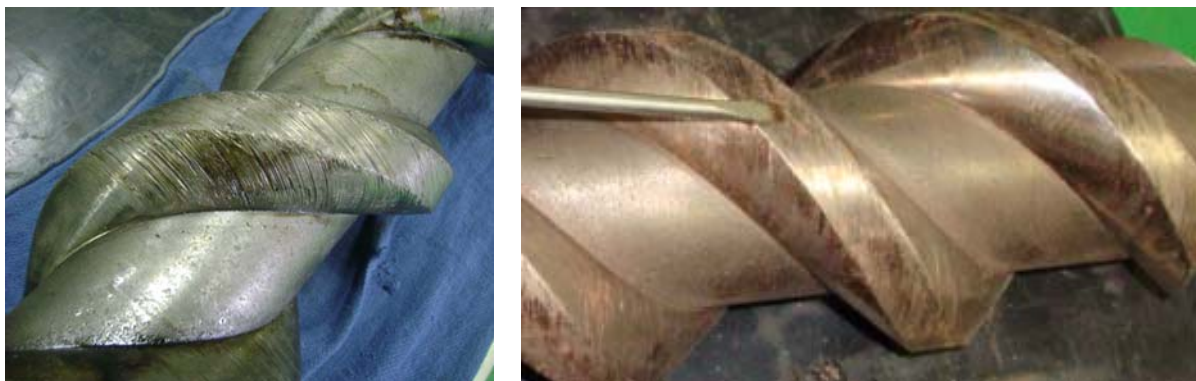
Figura 29 - Fuso principal com desgaste excessivo. Fonte: Relatório de manutenção da bomba.
