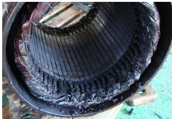
Figura 36 - Estator do motor queimado, com excesso de graxa e com sinais de que o rotor trabalhou em contato direto com o estator.
