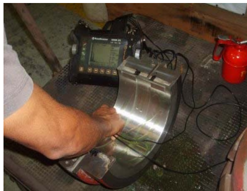
Figura 7 - Ensaio de ultrassom em um mancal de deslizamento.
