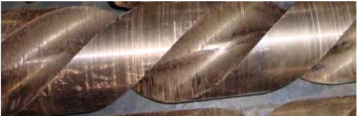
Figura 30 - Fusos movidos com desgaste excessivo. Fonte: Relatório de manutenção da bomba.
