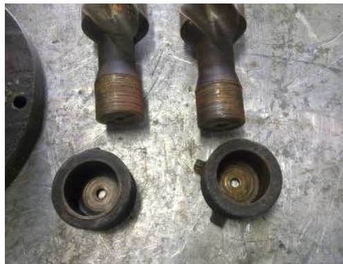
Figura 31 - Fusos movidos com desgaste excessivo nas buchas e ponta do eixo. Fonte: Relatório de manutenção da bomba.
