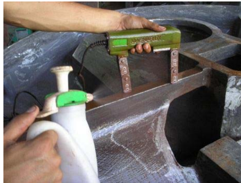
Figura 4 - Inspeção por partículas magnéticas. Fonte: Portal MB-Inspeções (2012).
