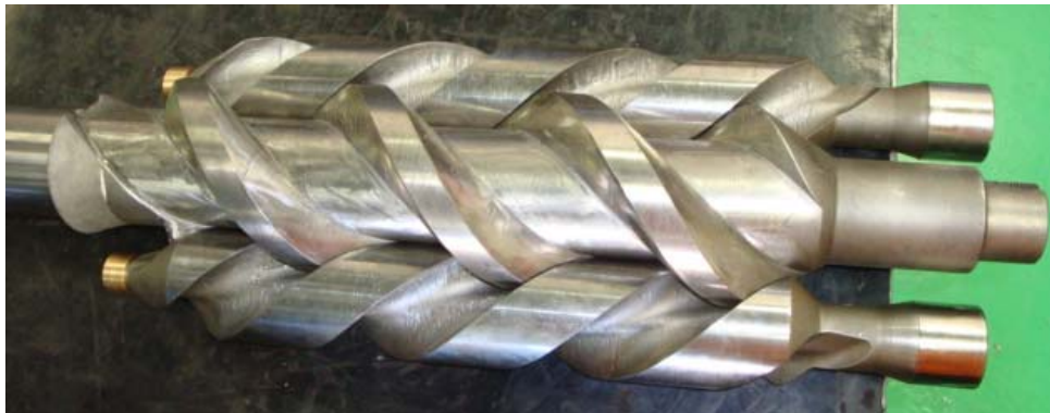
Figura 35 - Fuso principal e fusos movidos após recuperação. Fonte: Relatório de manutenção da bomba.
