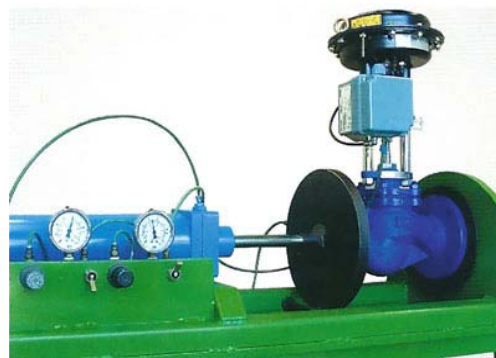
Figura 6 - Bancada de testes de estanqueidade em válvulas. Fonte: Torr Service (2012).
