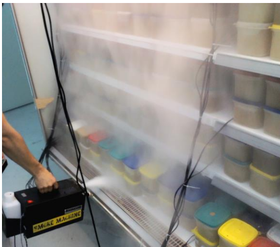
Figura 9 - Teste cortina de ar Fonte: Autoria própria.
