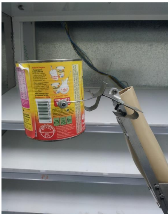
Figura 60 - Teste com lata Fonte: Autoria própria.
