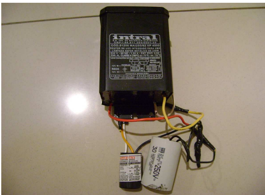
Figura 1 - Conjunto reator, capacitor e ignitor para lâmpadas de vapor metálico. Fonte: Autores
