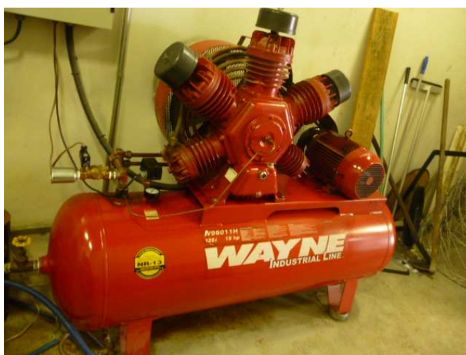
Figura 8 - Compressor principal. Fonte: Autores.
