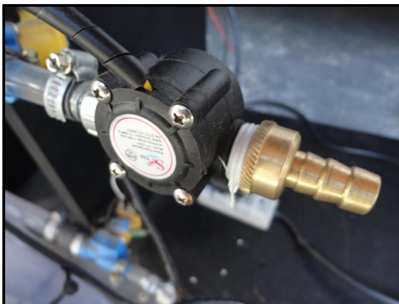
Figura 10: Sensor de vazão
