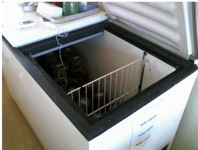
Figura 4 - Freezer 500 litros para realizar a cura
