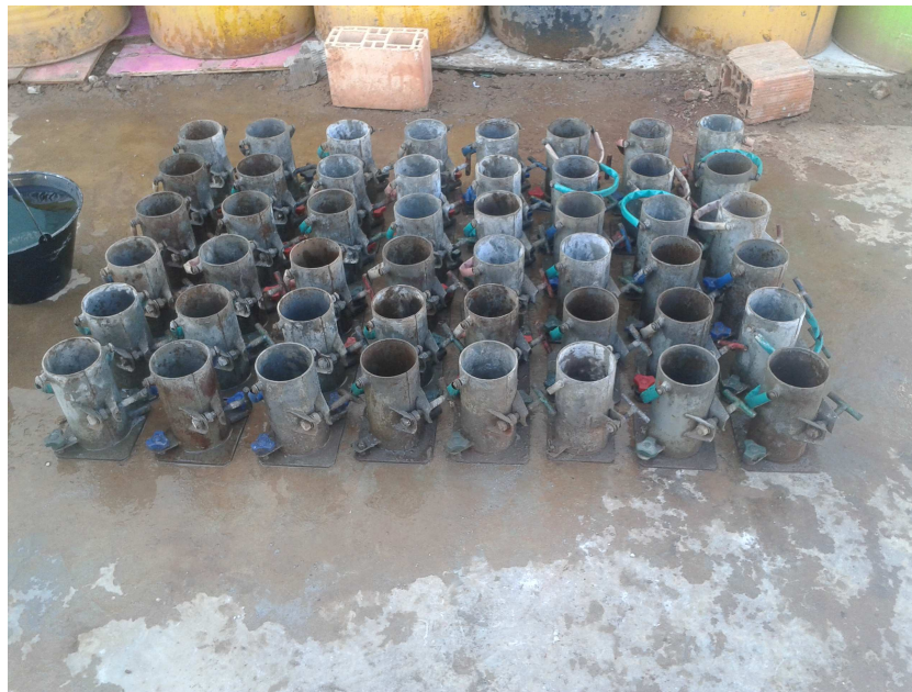
Figura 9 - Moldes dos corpos de prova 10 x 20 cm
