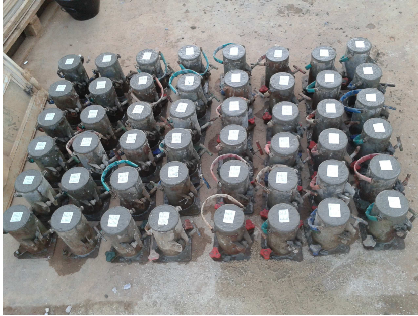
Figura 10 - Corpos de prova moldados, antes da cura
