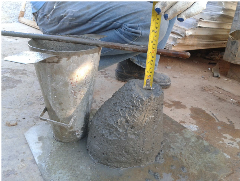
Figura 8 - Resultado do "Slump Test" - 90 mm
