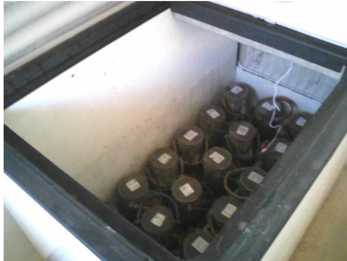
Figura 11 - Cura dos corpos de prova no freezer
