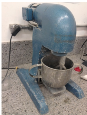
Figura 3.2 - Mistura do material na argamassadeira.
