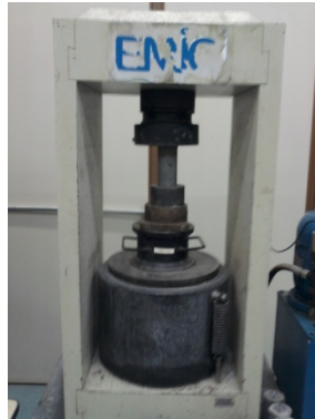
Figura 3.7 - Ensaio de compressão axial.
