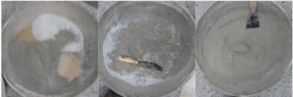
Figura 3.1 - Processo de mistura do material seco.
