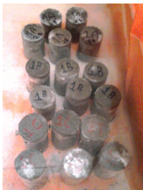
Figura 3.6 - Cura úmida dos corpos de prova.
