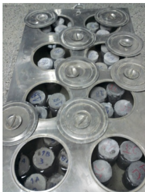
Figura 3.5 - Cura térmica dos corpos de prova.
