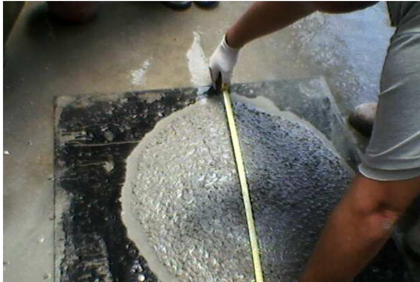
Figura 14 – Ensaio T500 - verificação de medidas.
