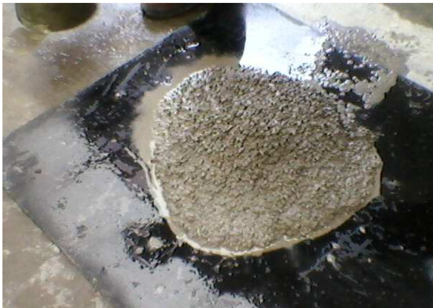
Figura 13 – Ensaio T500 em andamento – 1º tentativa
