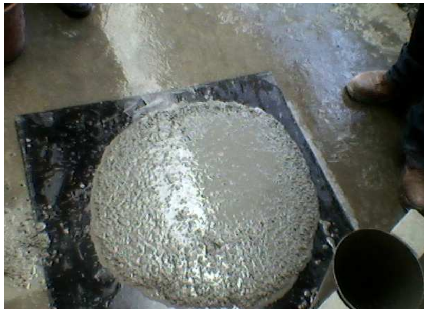
Figura 15 – Ensaio T500 em andamento, Sem segregação
