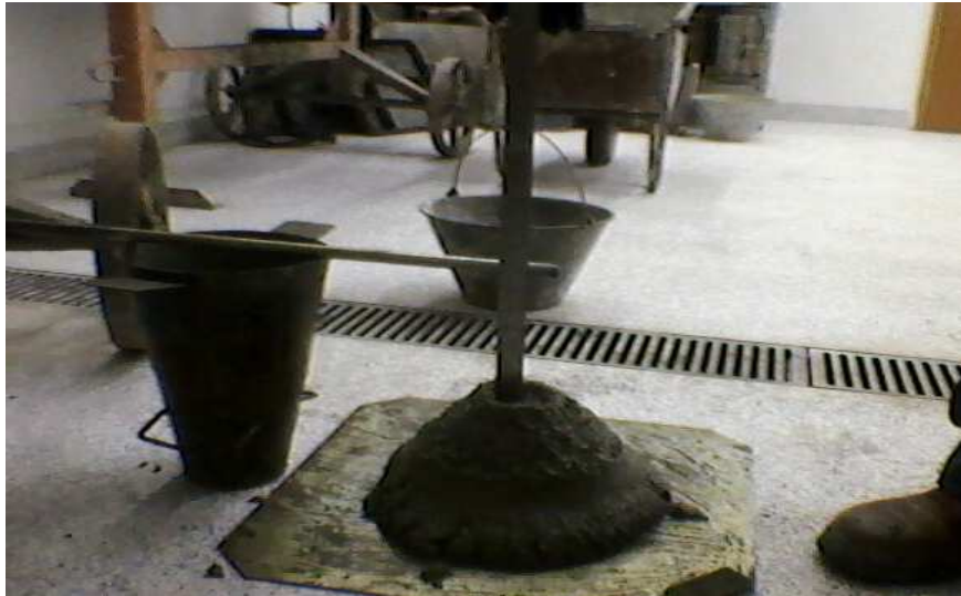
Figura 12 – Verificação do abatimento através do tronco de cone.
