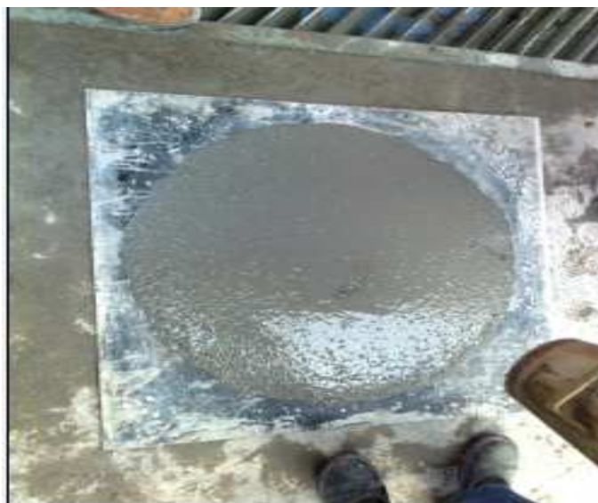
Figura 19 – Ensaio T500 Espalhamento do CAA.
