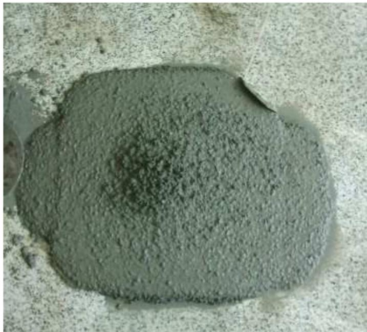
Figura 30 – Slump Flow Test, CAA 2, Fonte Própria.
