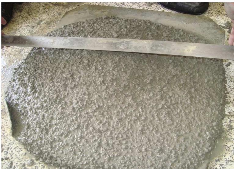
Figura 26 – *Slump Flow test* CAA 1, Fonte Própria.
