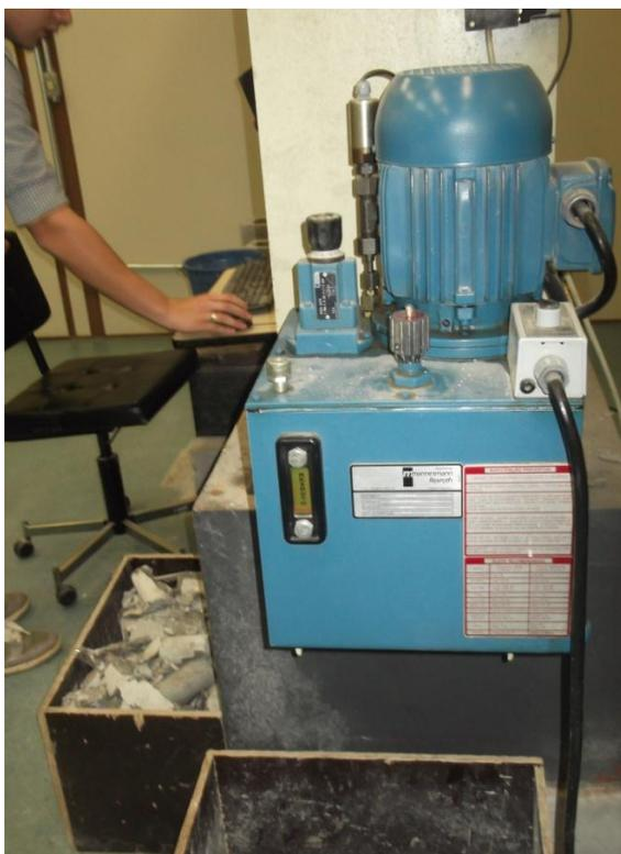
Figura 25 - Prensa utilizada para rompimento dos corpos de prova.
