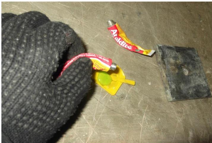
Figura 31 - Preparação da cola epóxi.
