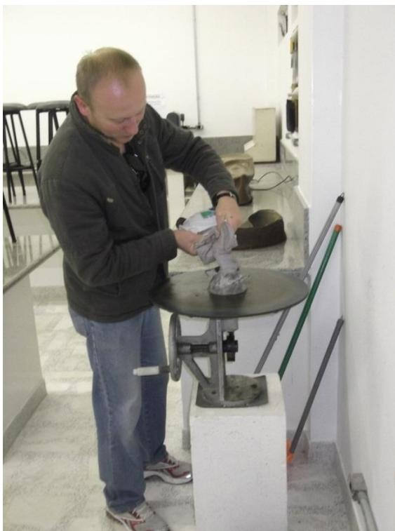
Figura 16 - Preenchimento do molde tronco cônico com a argamassa
