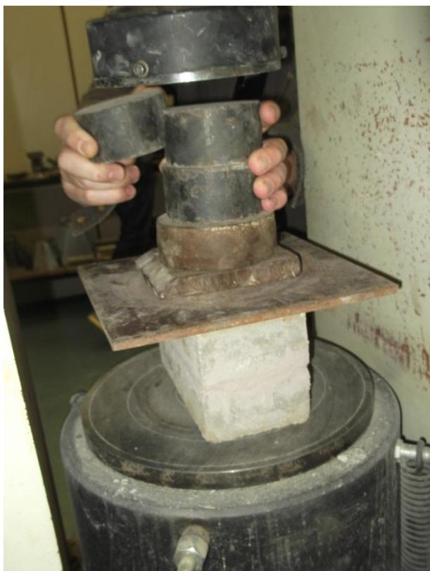
Figura 23 - Ensaio de compressão com corpo de prova prismático.
