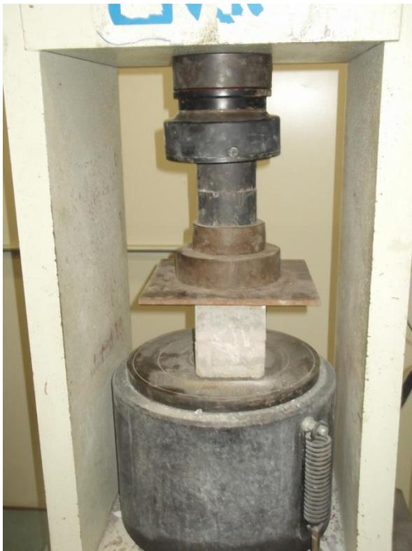
Figura 24 - Ensaio de compressão com corpo de prova prismático.
