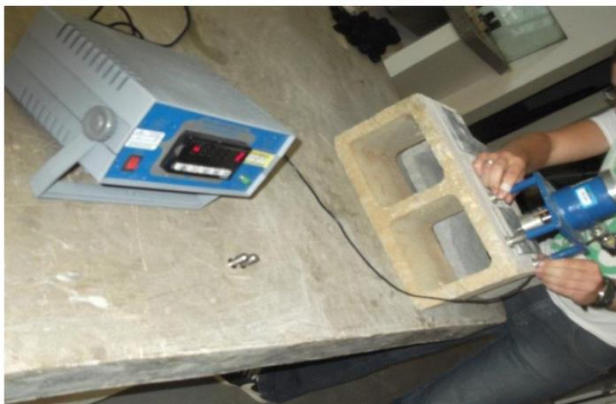
Figura 34 - Ensaio sendo realizado registrando a força em Kg.
