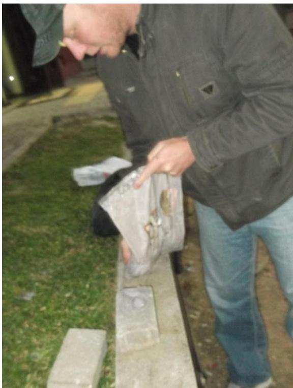
Figura 21 - Argamassa industrializada sendo utilizada para moldar corpo de prova prismático.
