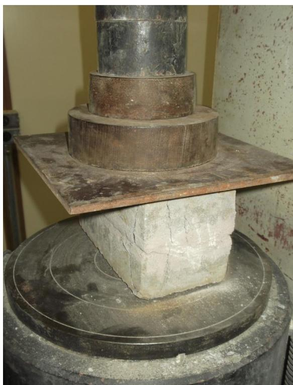
Figura 27 - Corpo de prova durante rompimento na prensa.
