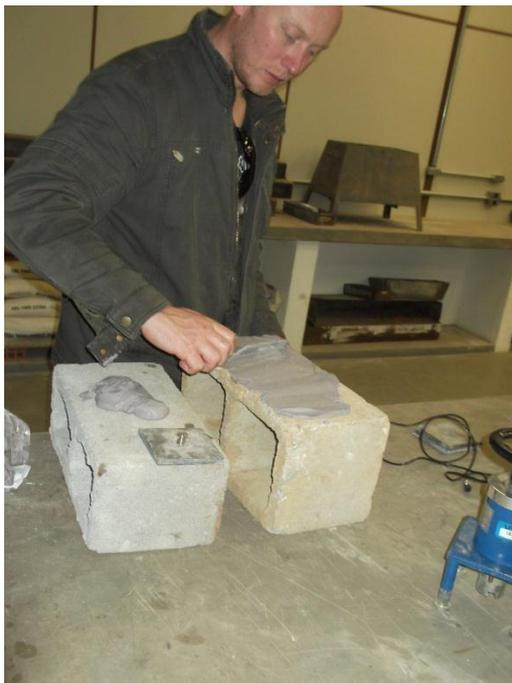
Figura 29 - Aplicação da argamassa sobre o substrato
