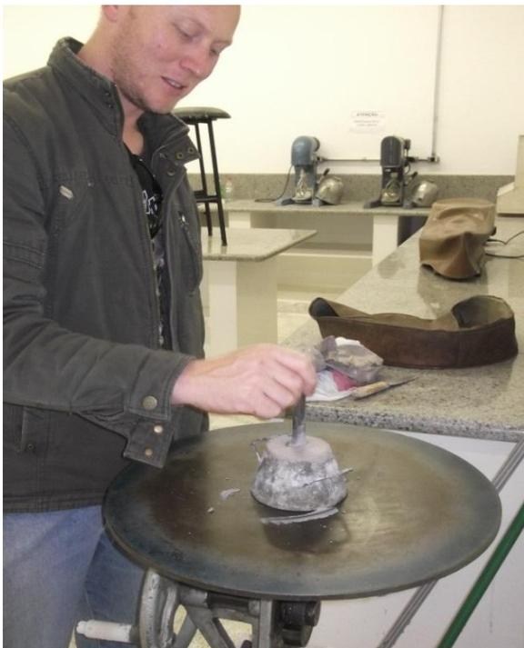
Figura 17 - Utilização do soquete para o preenchimento da argamassa no molde.
