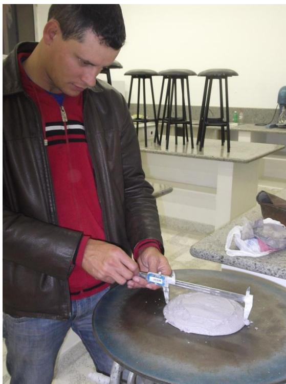
Figura 20 - Medição do espalhamento da argamassa
