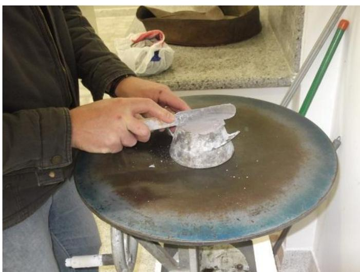
Figura 18 - Rasamento da argamassa no molde tronco cônico.
