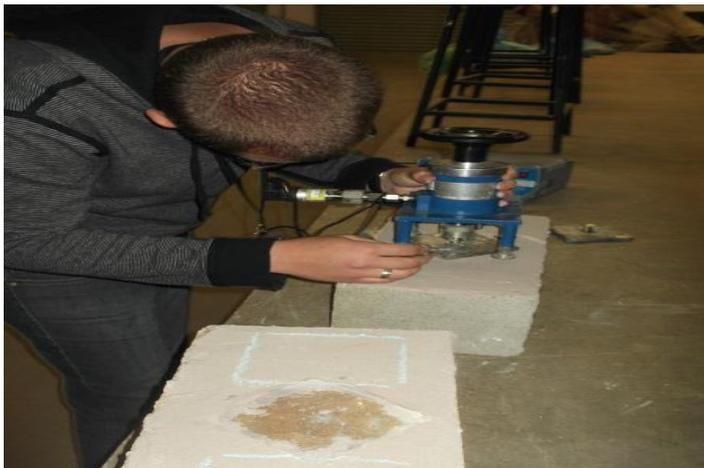
Figura 33 - Acoplamento do Aderímetro a placa metálica.
