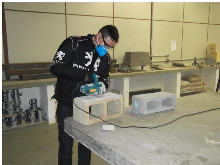
Figura 30 - Corte na argamassa após 28 dias de cura.
