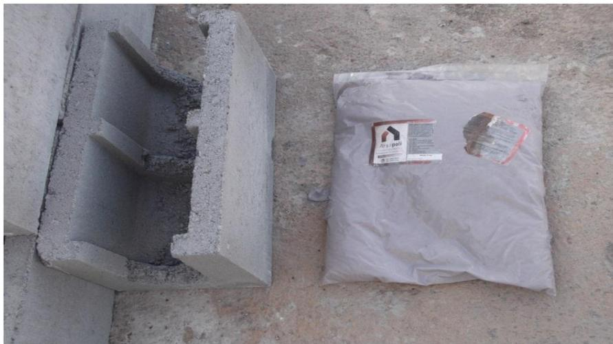
Figura 8 - Argamassa industrializada utilizada na Empresa Cristal Engenharia para assentamento de blocos de concreto.
