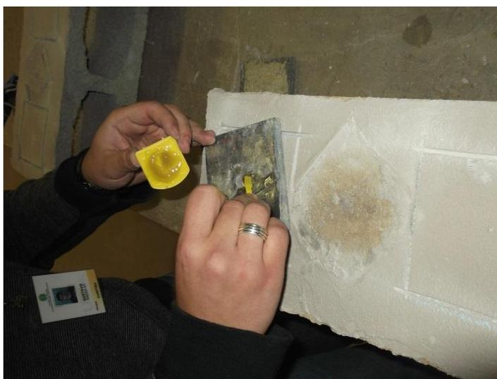
Figura 32 - Aplicação de cola na placa metálica.
