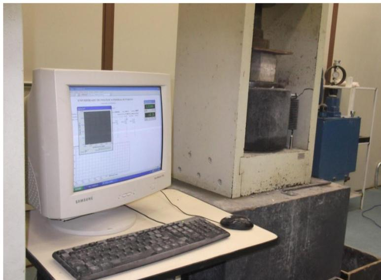
Figura 26 - Equipamentos utilizados para análise da compressão do corpo de prova.
