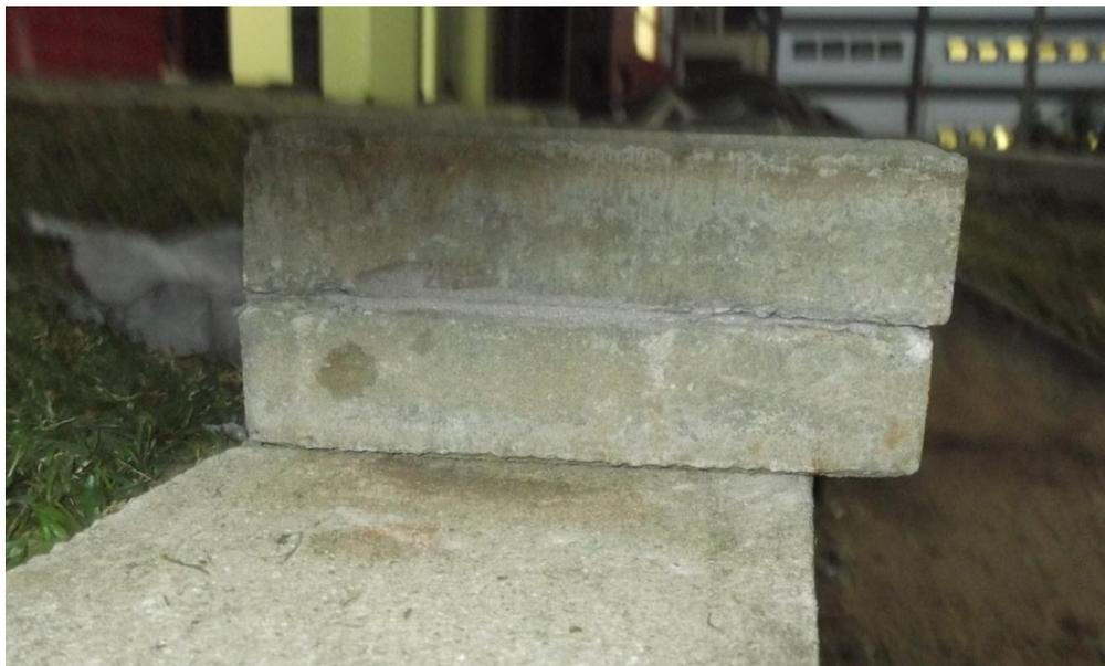
Figura 22 - Paver assentado para ensaio de resistência a compressão.
