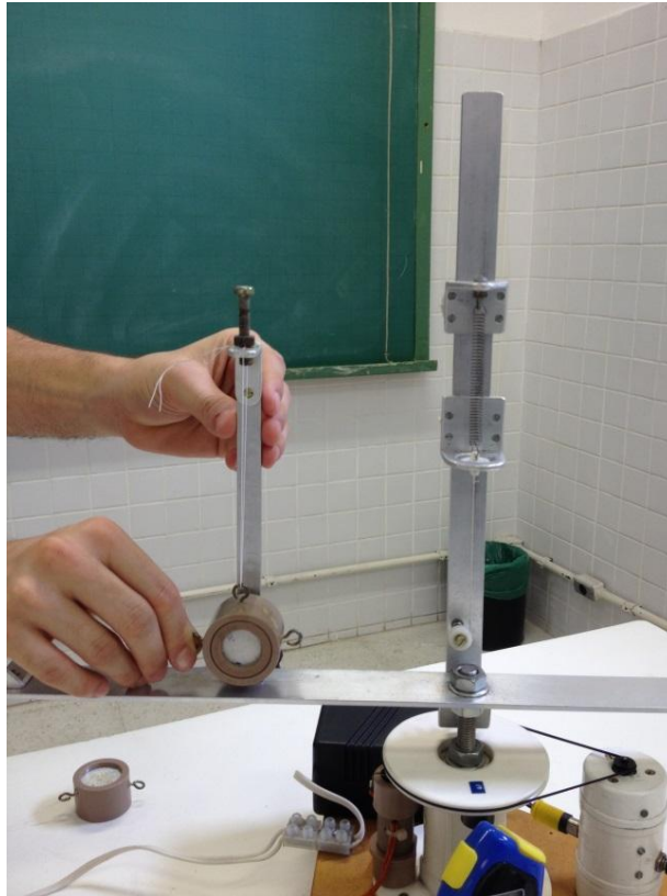
Figura 59 - Nivelando pastilha e movendo pilar lateral
