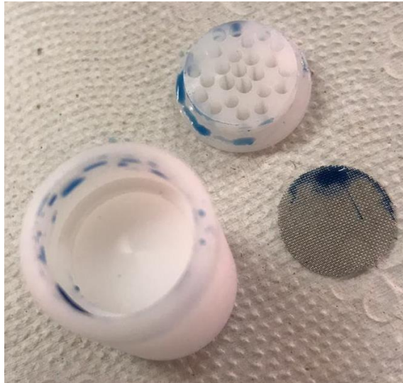
Figura 21 – Amostrador com solução de índigo carmin, referente a coleta do mês de junho de 2019, para o Ponto 1.
