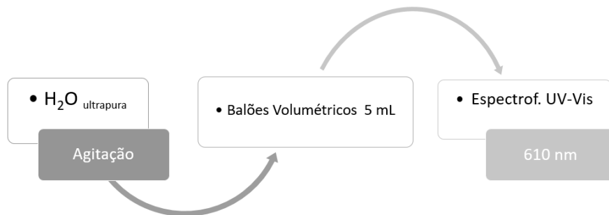
Figura 17 – Fluxograma do tratamento e quantificação do \text{O}_3 .
