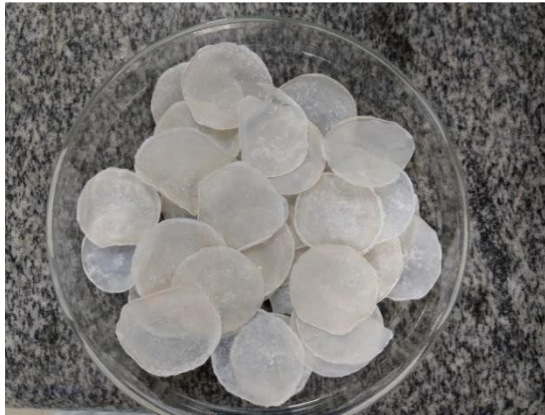
Figura 12. Membranas de CB-TiO 2 secas a 80 °C por 60 minutos em gel dryer.
