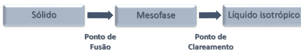
Figura 7. Denominação dos estados físicos percorridos por um material líquido cristalino durante o aquecimento.
