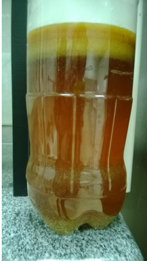
Figura 15. Obtenção da Glicerina Pré-purificada (fase intermediária) através da hidrólise ácida. Fonte: Autor
