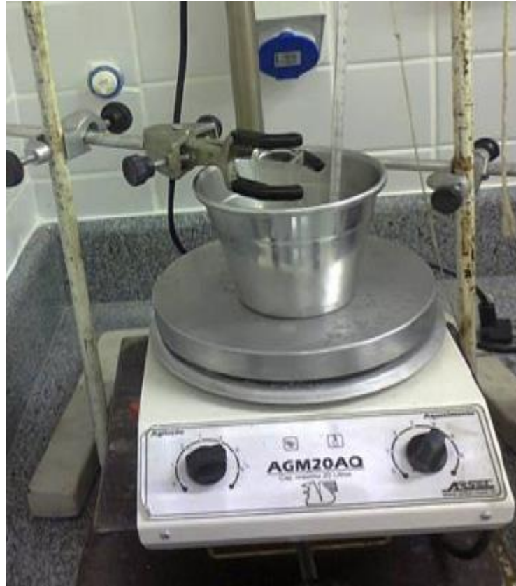
Figura 7. Sistema para neutralização da glicerina. Fonte: Autor
