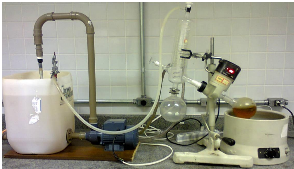
Figura 5. Evaporador rotatório utilizado na remoção do metanol residual da glicerina. Fonte: Autor
