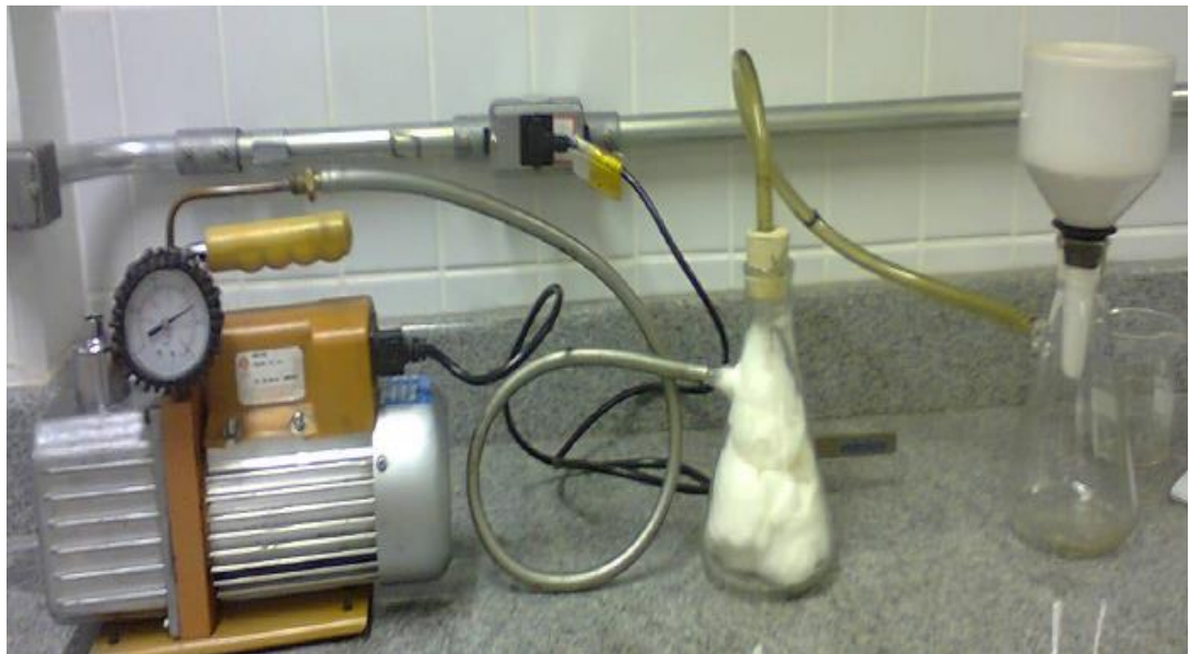
Figura 8. Sistema para filtração da amostra de glicerina neutralizada. Fonte: Autor
