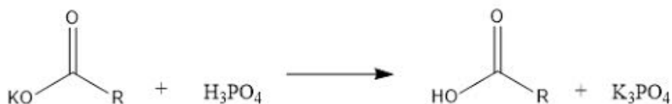
Figura 6. Formação de ácidos graxos e fosfato de potássio pela hidrólise ácida. Fonte: Autor
