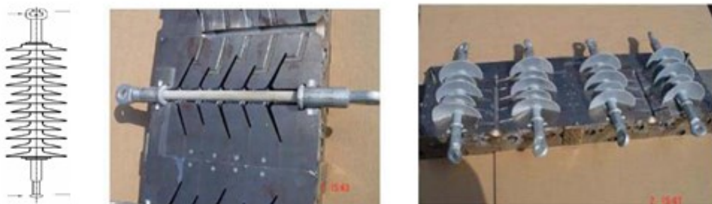
Figura 4. Método de produção de isolador polimérico. Fonte: Mora (2010).
