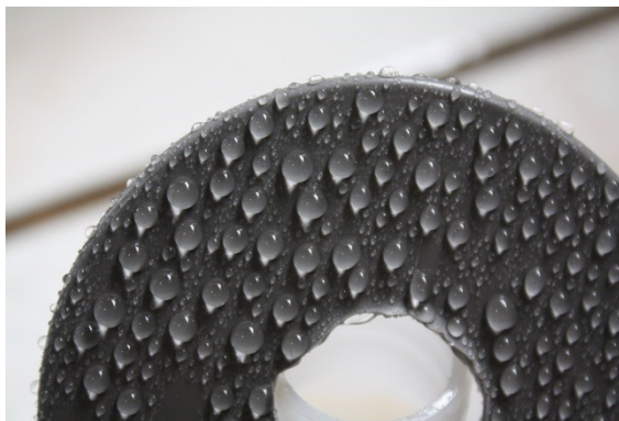
Figura 6. Superfície de um isolador com característica hidrofóbica.
