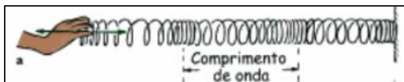
Figura 2 – Ilustração de ondas longitudinais produzidas numa mola Fonte: Hewitt, 2002 p 335
