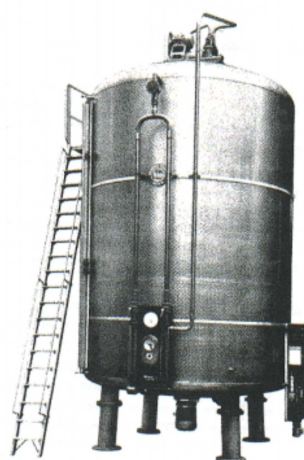
Figura 14: Acetificador do tipo Frings em aço inoxidável. Fonte: EMBRAPA (2006) por MECCA (1979).
