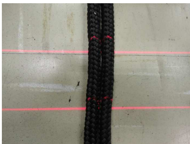
Figura 37 - Laser incidindo sobre o cordão de testes
