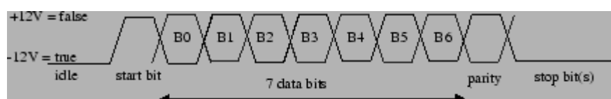
Figura 3 - Palavra transmitida no protocolo RS232
