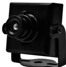
Figura 11 - Câmera com CCD modelo NS-C3901N da Sony
