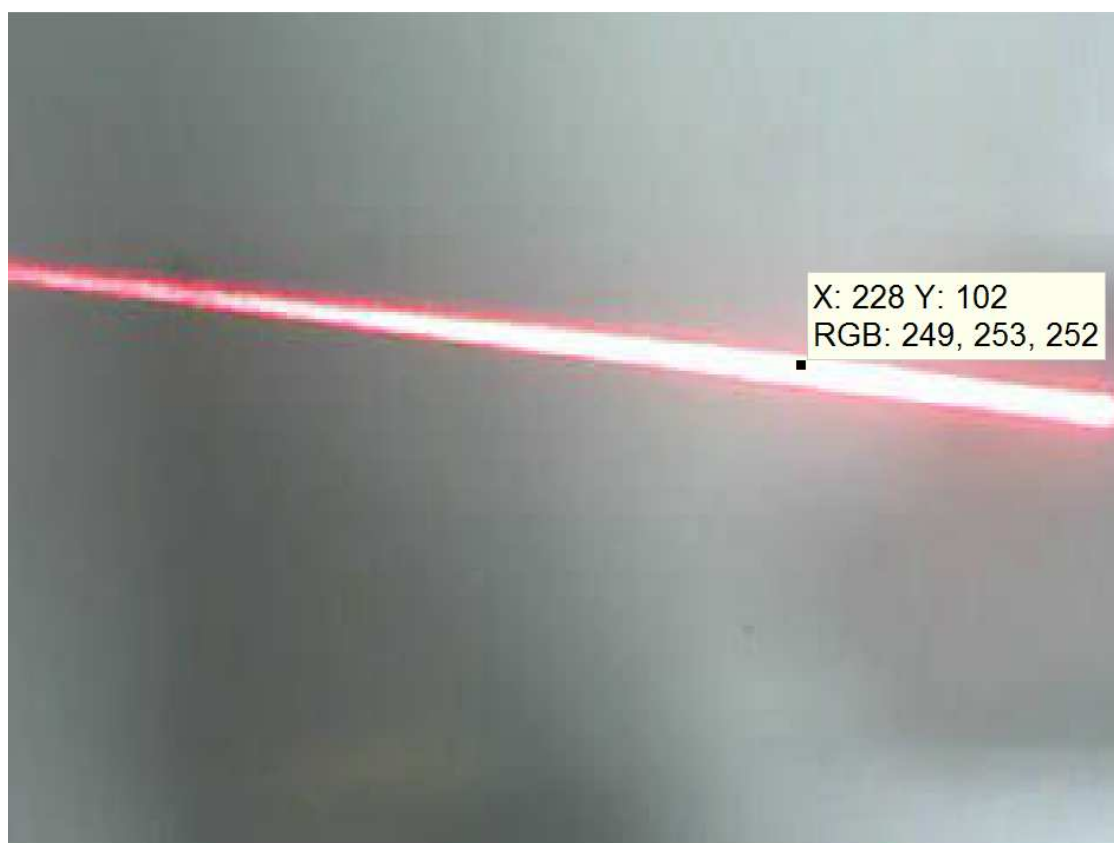
Figura 19 - Saturação da parte interna do feixe de laser
