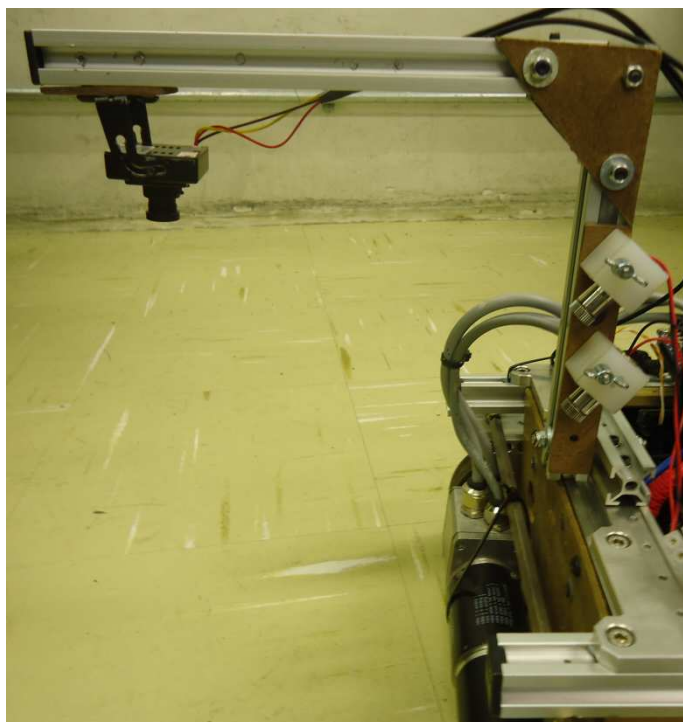
Figura 26 - Estrutura fixa da câmera e dos lasers
