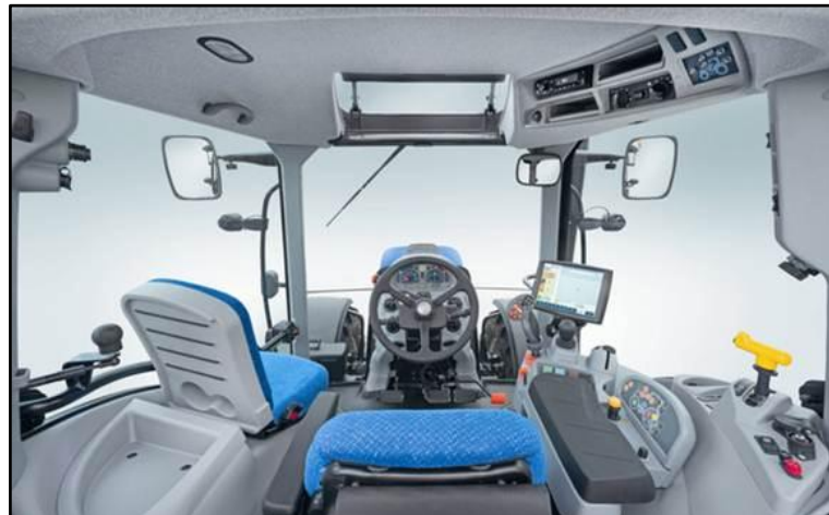
Figura 22 - Um único terminal para controlar implementos. Fonte: CNH Latin America.
