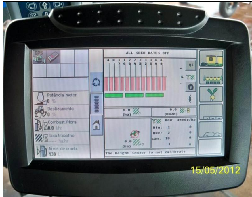
Figura 24 - Display apresentando informações de uma plantadeira de outro fabricante. Fonte: CNH Latin America.
