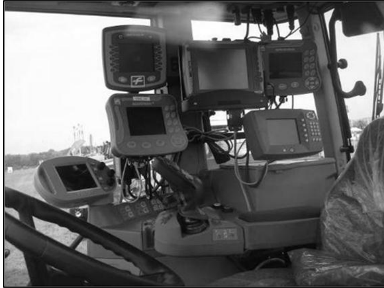
Figura 20 - Uso de múltiplos terminais para controlar implementos. Fonte: CNH Latin America.
