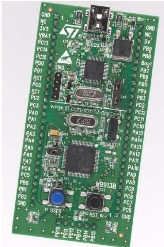
**Figura 4.** Kit STM32VL5Discovery, responsável pelo controle do módulo de identificação.
