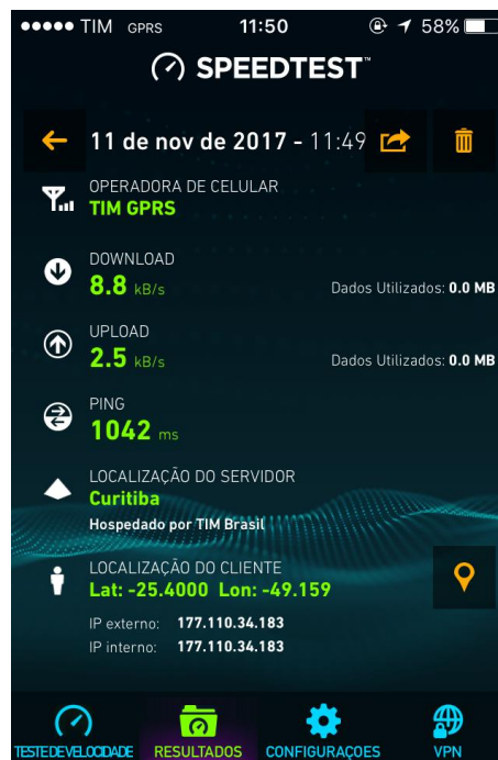
Figura 3: Medição de velocidade e latência GPRS.
