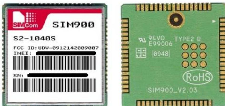
Figura 20 – Módulo GPRS SIMCom SIM900B
