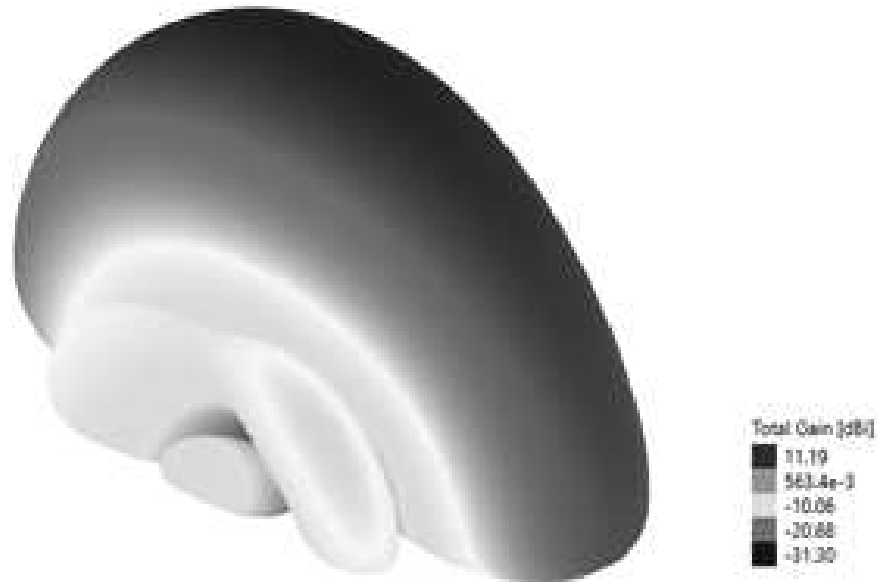
Figura 60 – Diagrama de radiação do projeto da matriz de antena 4x1
