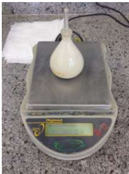
Figura 17 – Definição da massa específica unitária com o frasco aferido. Fonte: Autoria Própria.
