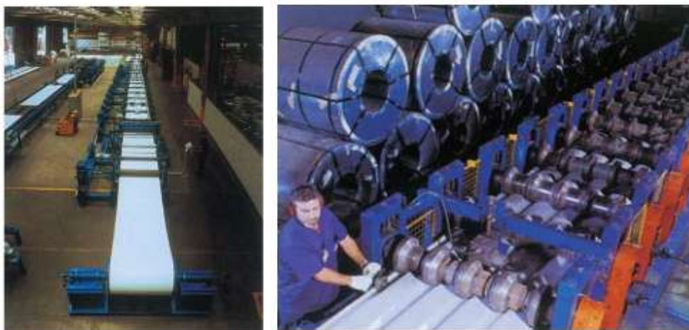
Figura 7 - Processo de fabricação de telhas de aço.
