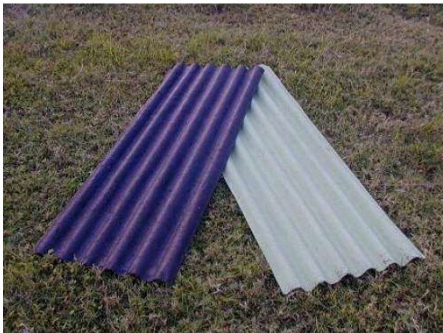
Figura 9 - "Telha ecológica", com impermeabilização (esquerda) e sem impermeabilização (direita). Fonte: Passos, 2005.
