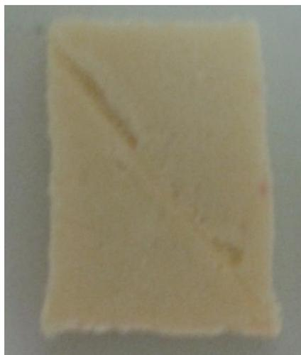
**Figura 20 – Amostra da espuma de PU derivada de óleo de mamona**
