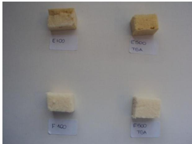
**Figura 21 - Amostras após tratamento térmico**
