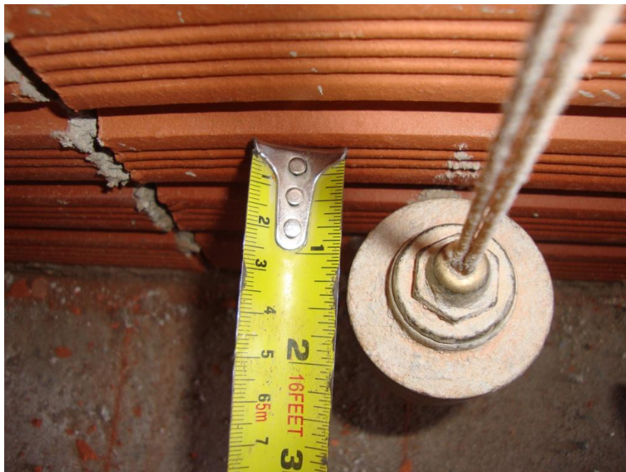
Figura 14 - Medição da diferença de prumo Fonte – Autoria própria
