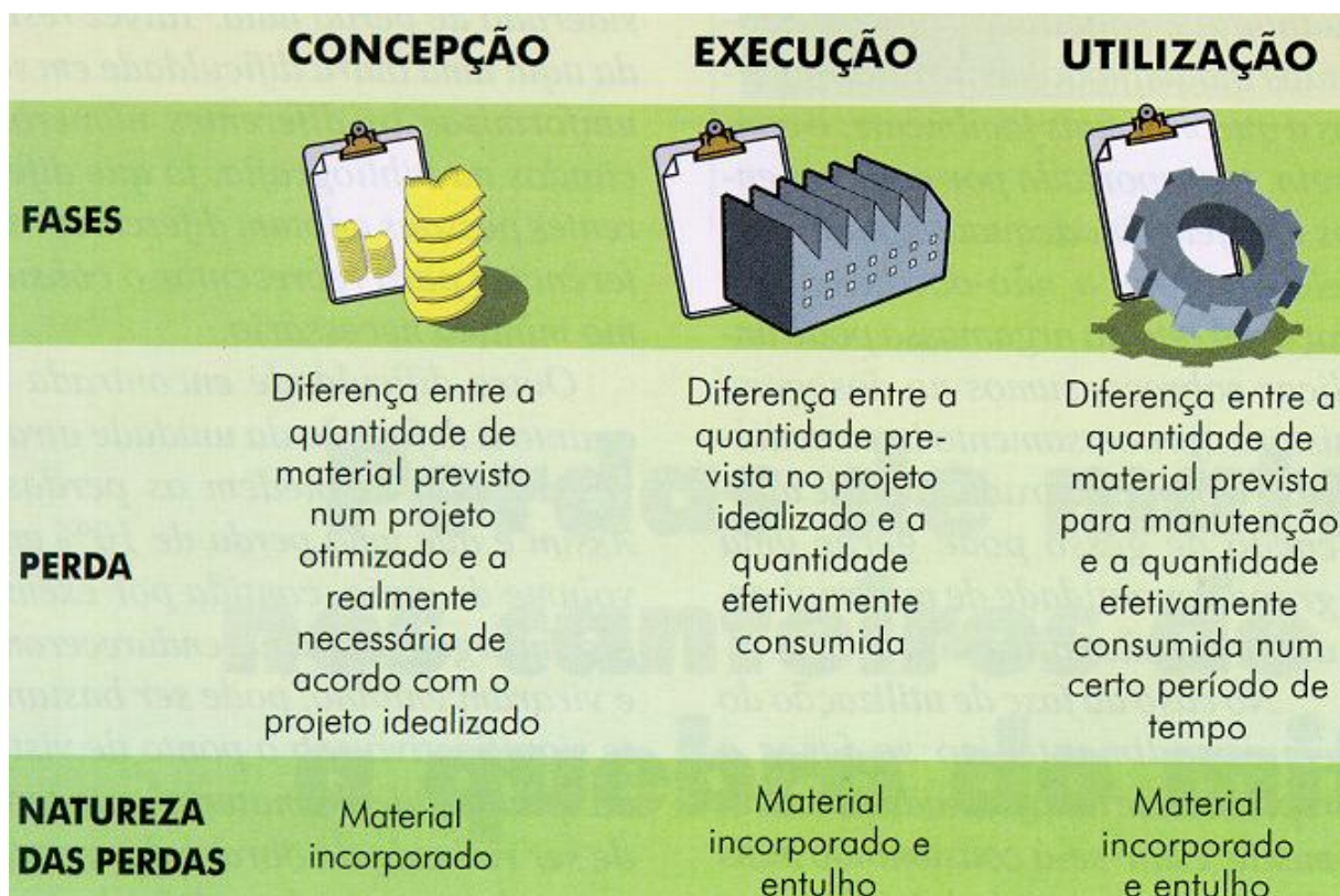
Figura 6 - Diferentes fases de um empreendimento e ocorrência de perda de recursos físicos Fonte: Souza et al., 2005
