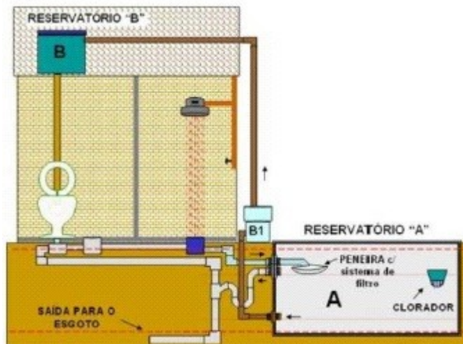
Figura 49. Sistema de reúso da água do chuveiro (Fonte: Sociedade do Sol, 2003).
