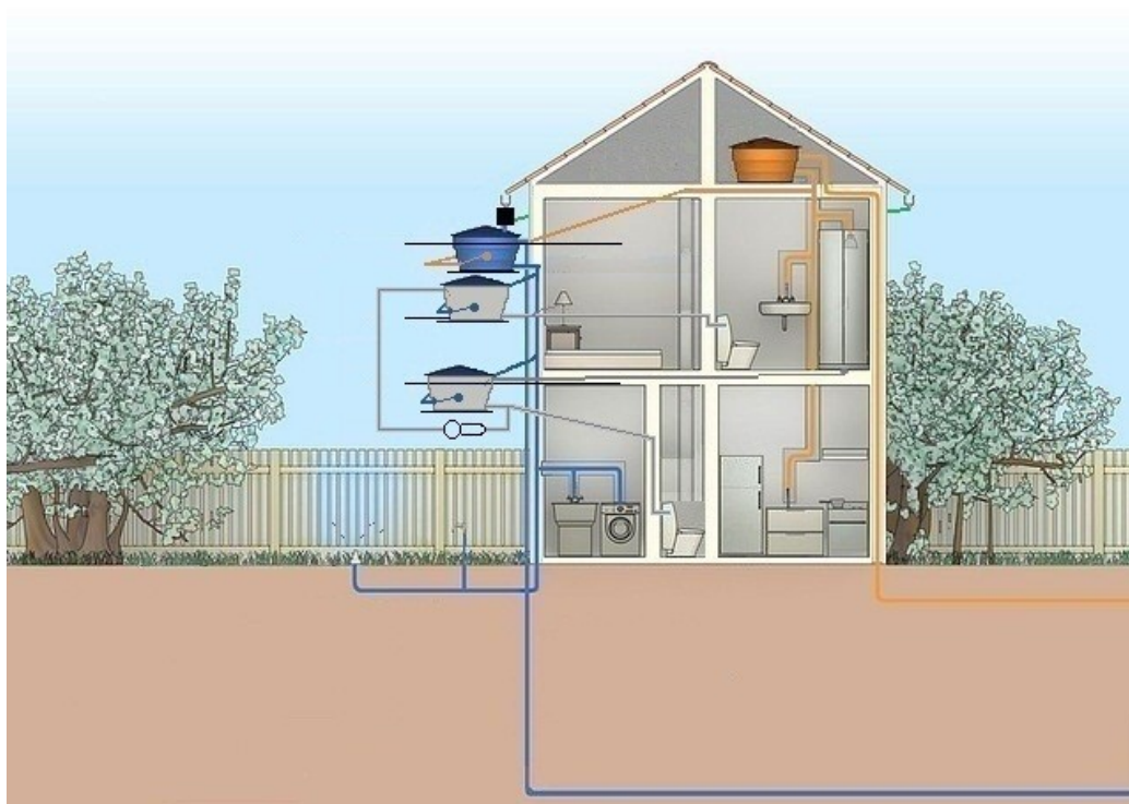
Figura 40. Instalação da bomba de água cinza.
