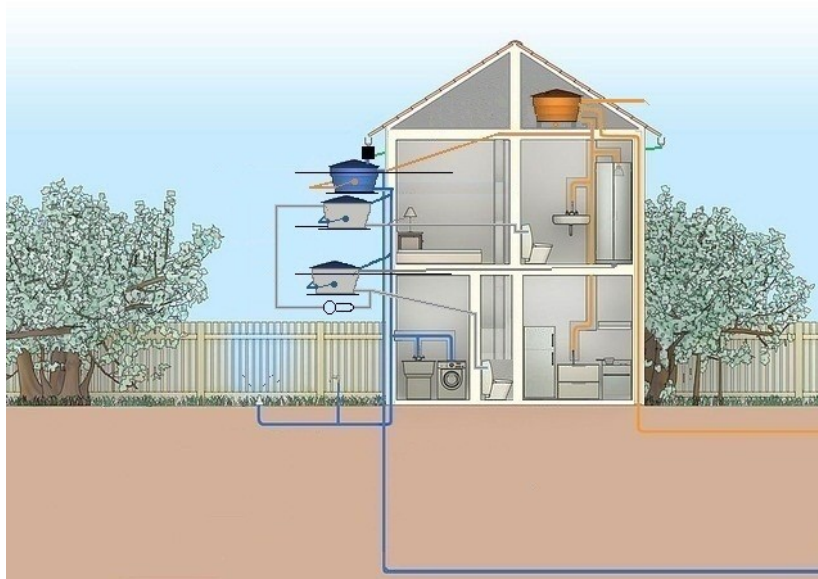
Figura 42. Instalação alterada do reservatório de água tratada.
