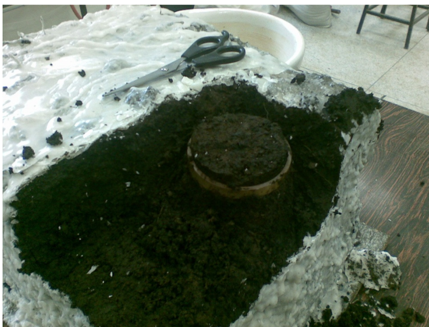
Figura 8 - Modelação da amostra para o ensaio.
