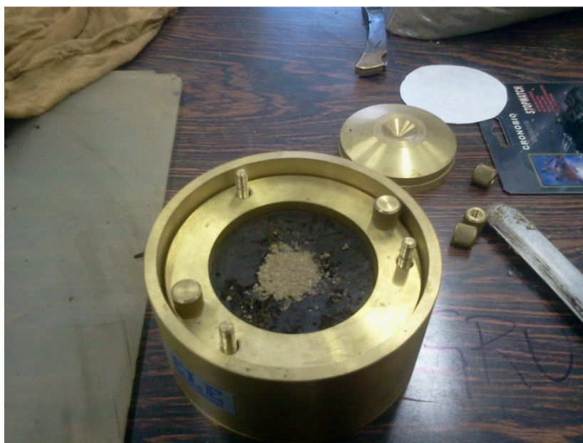
Figura 11 - Amostra preparada com a coluna de areia.
