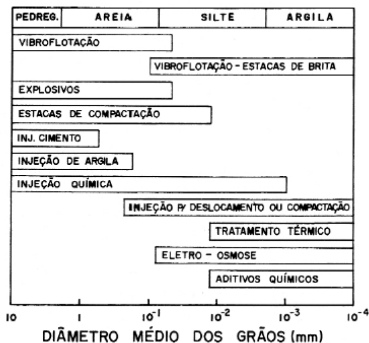
Figura 1 - Técnica de melhoria em função da granulometria (Mitchell, 1968)
