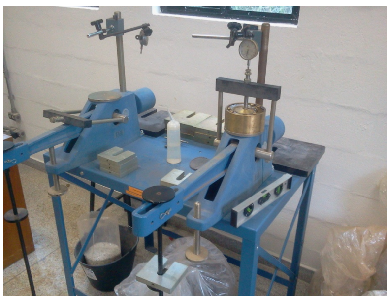
Figura 12 - Início do ensaio de adensamento.
