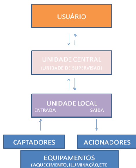
Figura 2.2 - Funcionamento da GTB.
